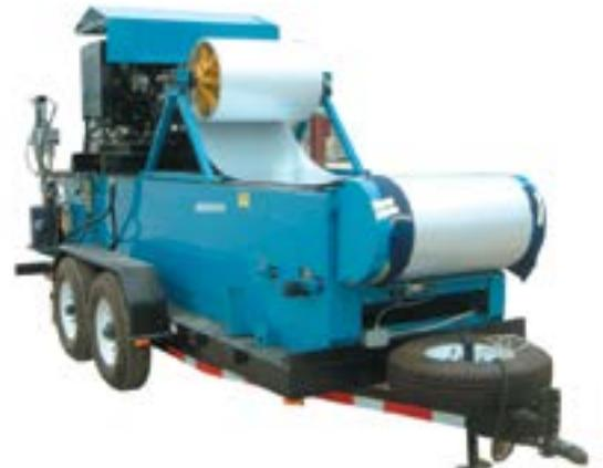
Máy cán di động sẽ được sử dụng trong trường hợp không muốn có các mối nối đầu trong hệ thống mái. Máy cán có trọng lượng khoảng 3,5 tấn, có thể vận chuyển đến công trường bằng container. Với công suất cán từ 12-15m/phút, những tấm mái MaxSEAM® có thể được cán liên tục tại công trường với chiều dài lên đến 100m. Tùy vào quy mô và yêu cầu của dự án, Zamil Steel Việt Nam sẽ thảo luận với khách hàng về việc cán tấm mái MaxSEAM® có độ dài trên 50 m ngay tại công trường.
